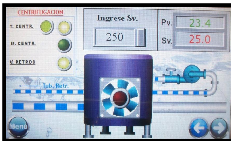
Figura 9: Transferencias y Purificación de Combustible - HMI
