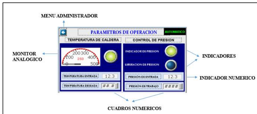
Figura 33: Control de temperatura y presión de caldera HMI. Elaborado por el autor.
