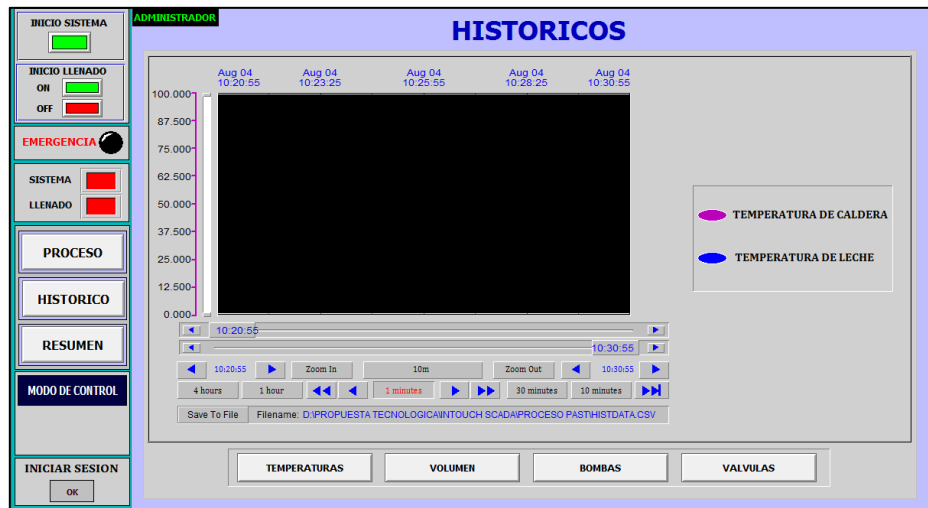
Figura 28: Ventana de histórico de datos SCADA. Elaborado por el autor.
