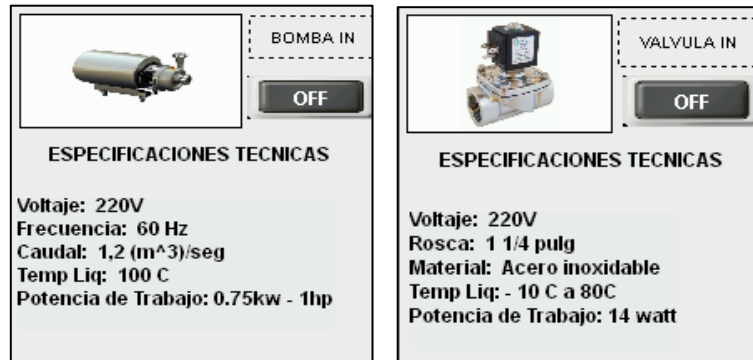
Figura 36: Activación de bomba y electroválvula HMI. Elaborado por el autor.
