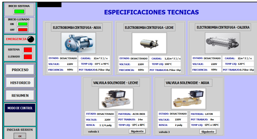
Figura 29: Ventana de resumen SCADA. Elaborado por el autor.
