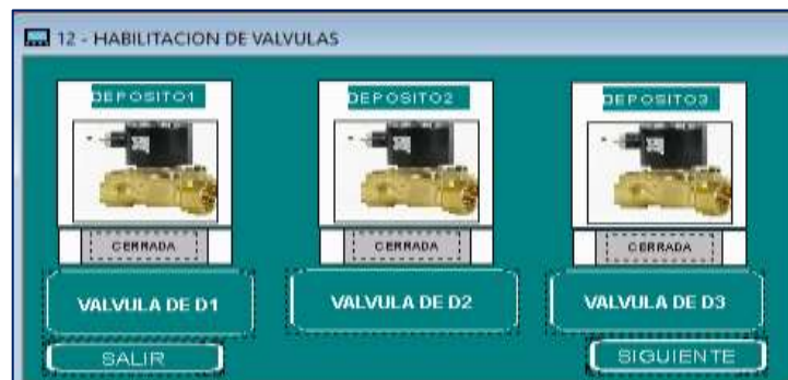
Ilustración 62: Electroválvulas de depósitos de detergente
