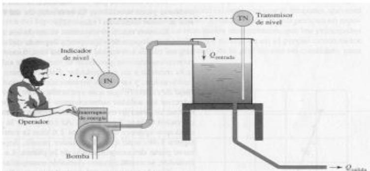
Figura 75. Control manual de lazo cerrado del nivel del tanque (Web)
