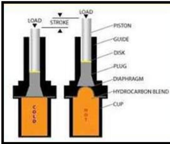
Figura 57. Actuador Térmico (Web mitecnologico.com)
