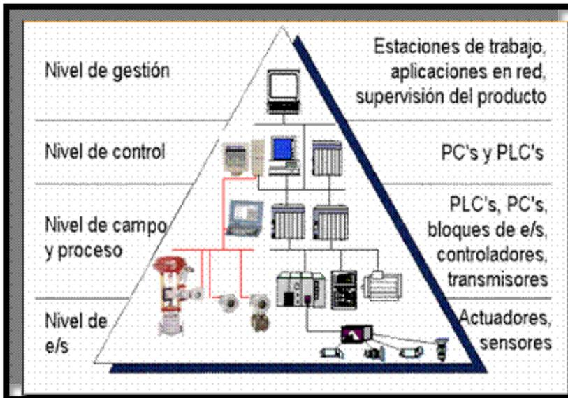
Figura 67. Niveles de Instrumentación virtual (Web)
