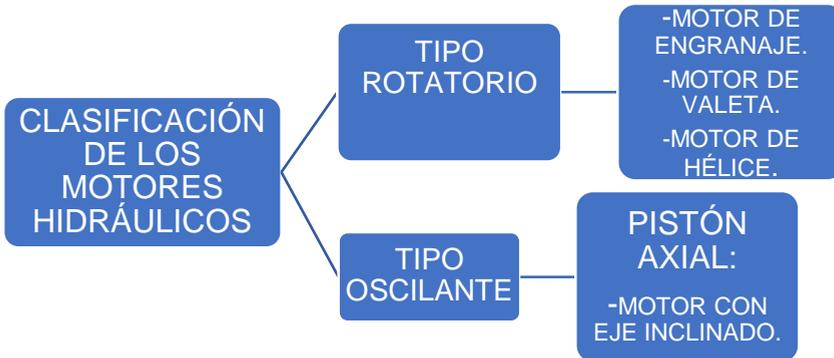
Figura 36. Clasificación de los motores hidráulicos
