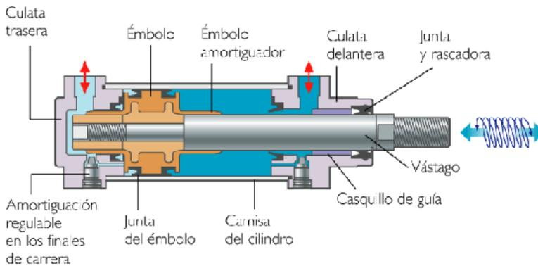
Figura 39. Actuador Neumático (Web)
