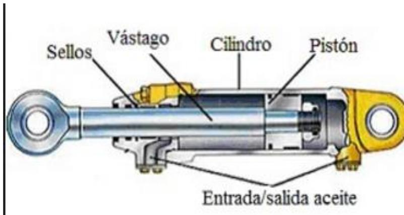
Figura 34. Cilindro de efecto doble (Web)
