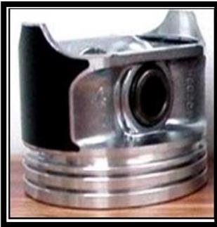
Figura 52. Pistón con capa de Recubrimiento (Web)
