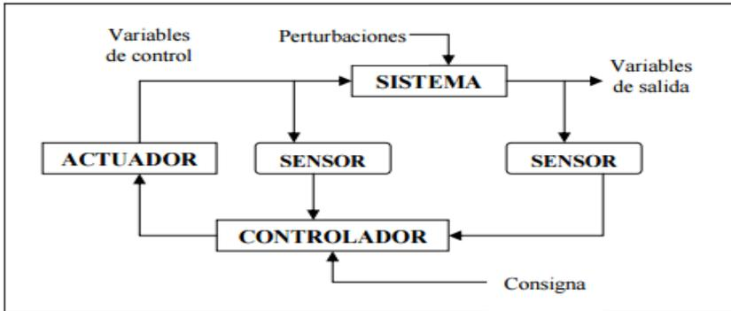
Figura 74. Elementos básicos de un s.c. (Web)
