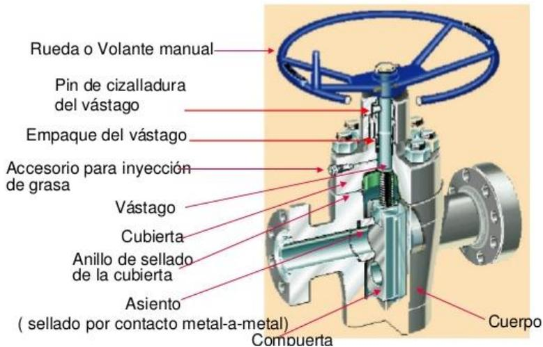
Figura 41. Válvulas de compuerta (Web)
