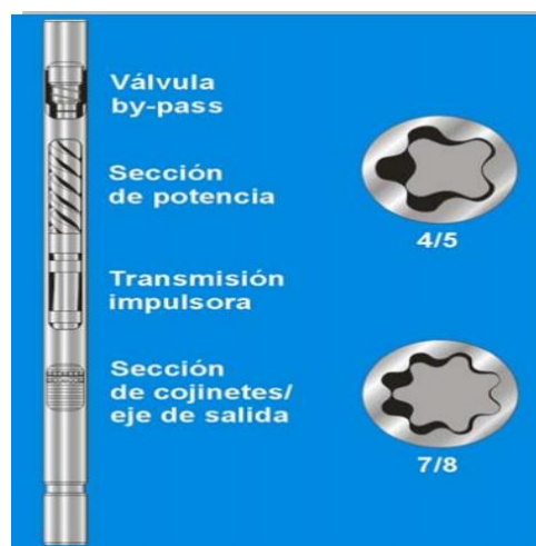
Figura 2.14: Motor de fondo-PDM. Fuente: (Calero, 2011) Diseño de Sartas y Perforación Direccional.
