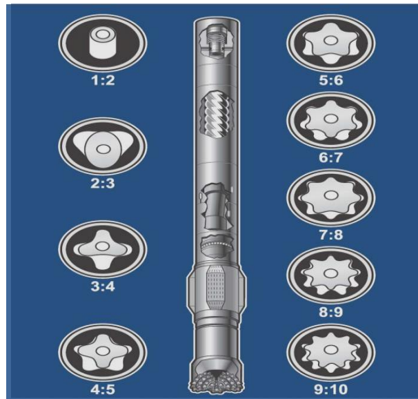
Figura 2.15: Relación Rotor/Estator de motores de fondo PDM.
