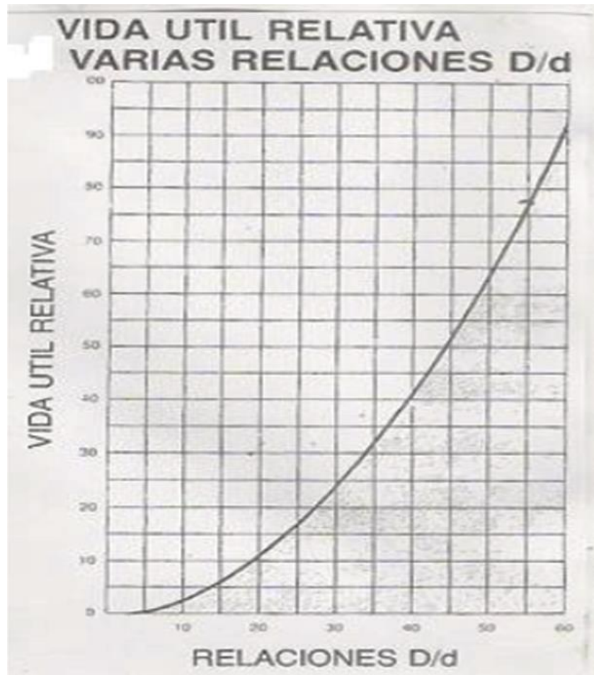
Fig. 16. Diagrama de variación de la vida útil del cable.
