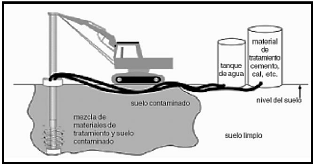
Fig. 24. Proceso de Estabilización/Solidificación.
