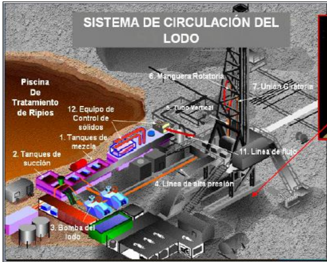
Fig. 4. Circuito del Fluido de Perforación.
