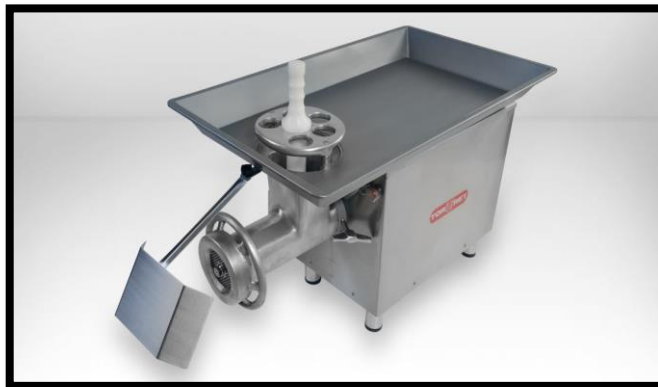
Imagen N° 14 Molino Industrial de 3 HP.
