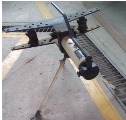
FOTO N° 7 DOBLADORA DE TUBOS
