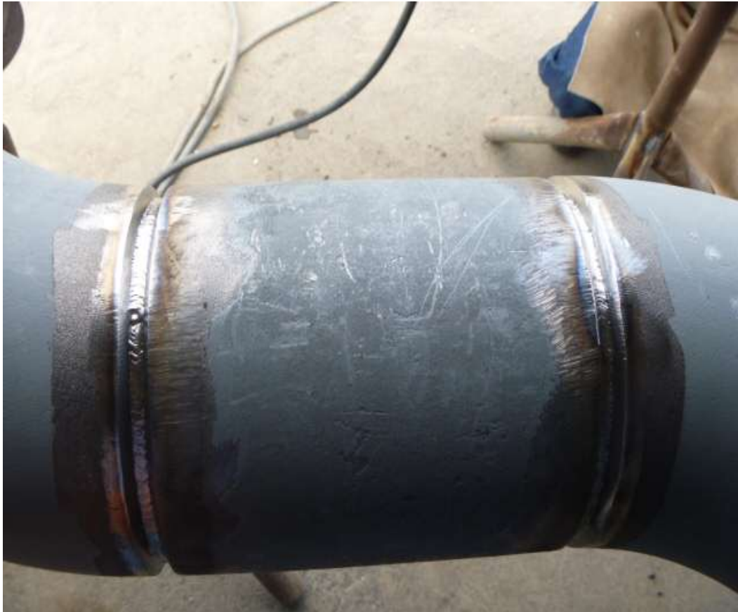
GRÁFICO #17 INSPECCIÓN VISUAL DE CORDONES
