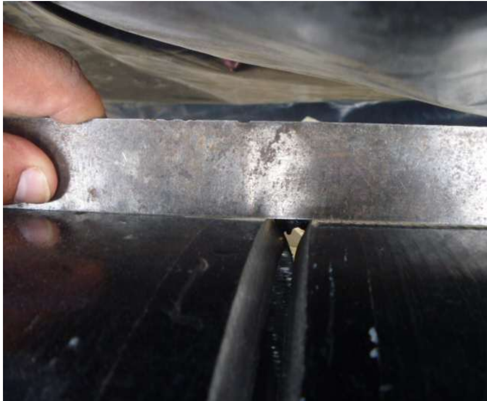
GRÁFICO #13 INSPECCIÓN DE ALINEADO
