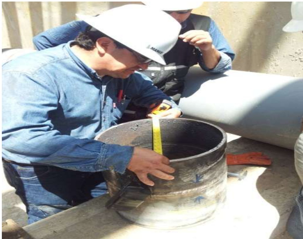
GRÁFICO #11 INSPECCIÓN GEOMÉTRICA
