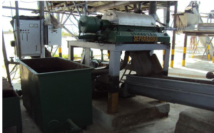
Imagen. # 23. Separadora de Sólidos-Reservorio Pequeño
