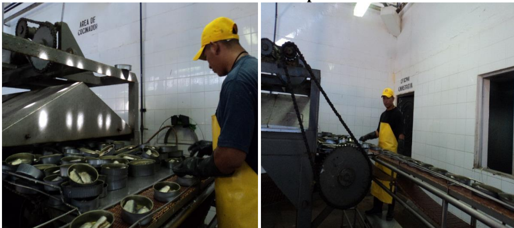
Gráfico No. 10 Colocación del producto en latas
