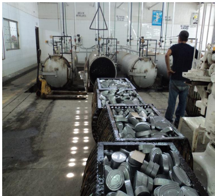
Gráfico No. 16 Esterilización del producto
