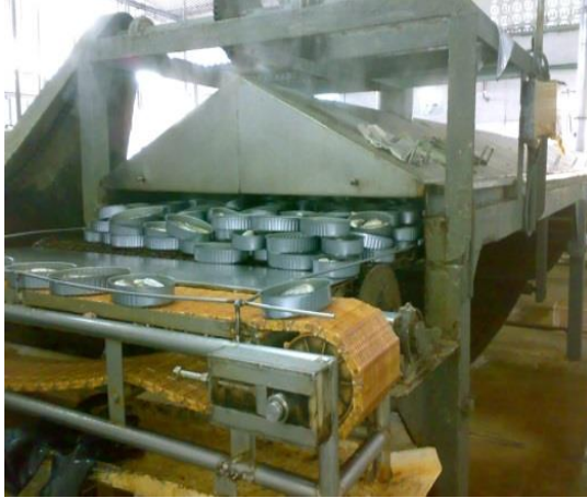
Gráfico No. 11 Cocción del producto en latas
