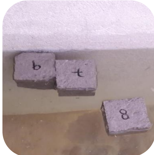
Mini paneles flotando de acuerdo a la densidad.
