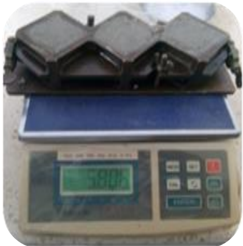
Prueba en la báscula, el peso del hormigón celular.
