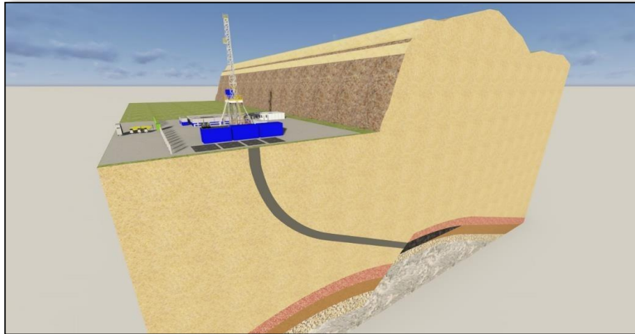
Imagen 6. Perforación a través de un plano de falla. (Rezabala, 2017).
