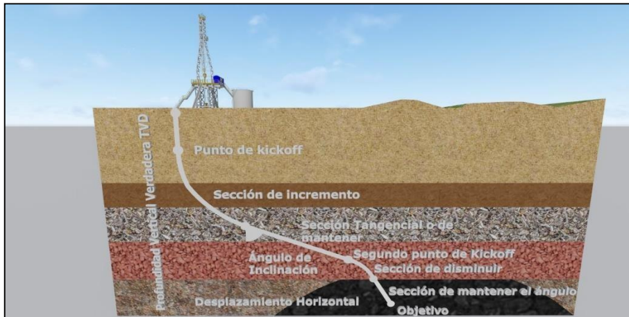
Imagen 12. Trayectoria de incrementar y mantener y disminuir parcialmente, también llamada “S”. (Build, partial drop and hold). (Rezabala, 2017).
