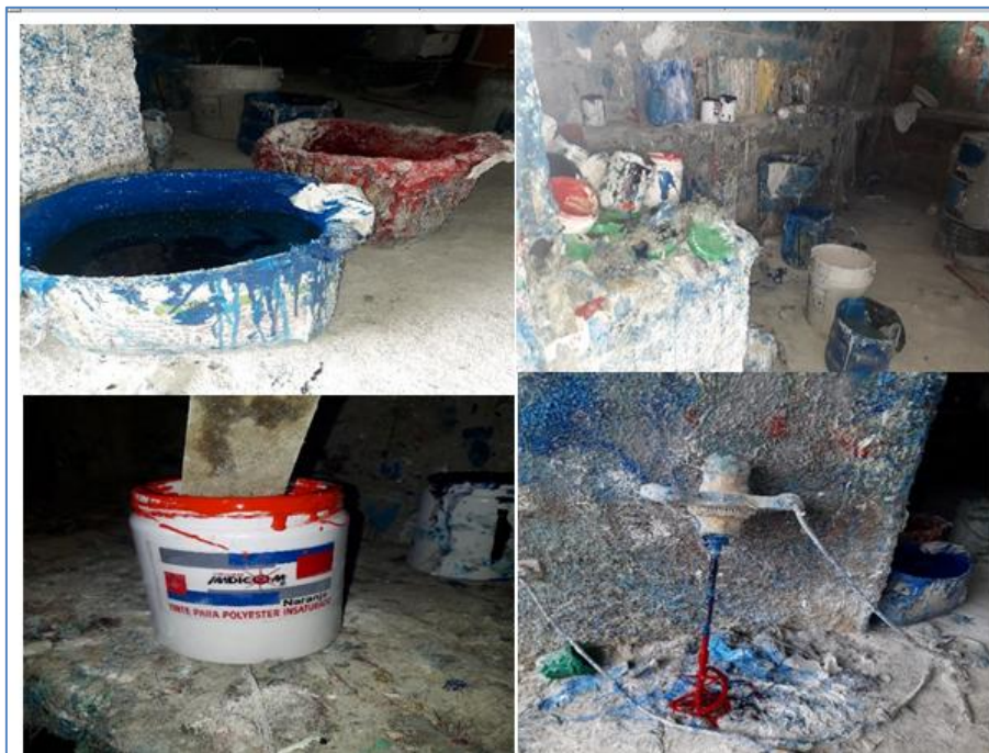
Gráfico 25. Lugares y herramientas donde se prepara la pintura Gelcoat.
