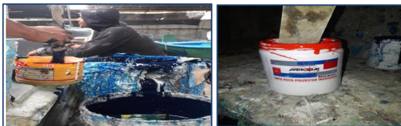
Gráfico 32. Preparación de pintura (Gelcoat).
