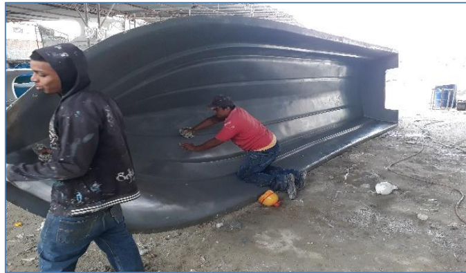
Gráfico 31. Encerado del molde de fibra de vidrio.
