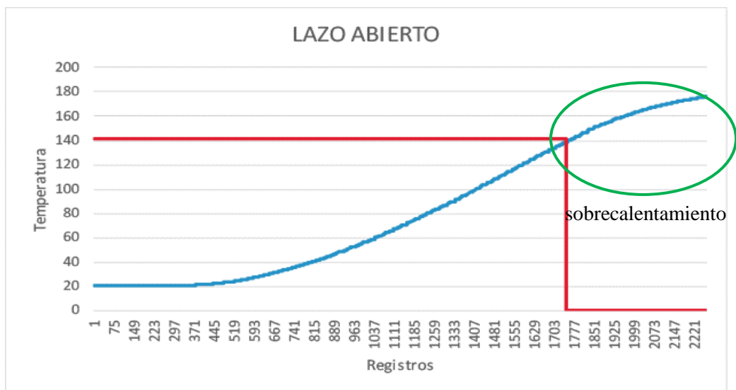
Figura 27. Contraste entre la salida de la planta y estado de relé.
