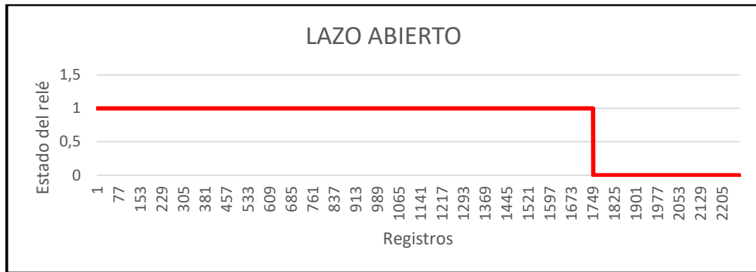
Figura 26. Estados del relé – Lazo abierto.
