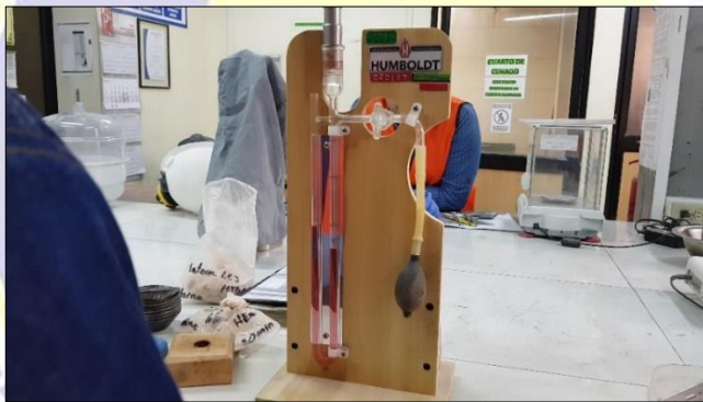
Figura 8 Cápsula colocada herméticamente en el aparato para Ensayo de Blaine. Fuente: Félix Castillo Jumbo – Ronny Reyes Villamar.
