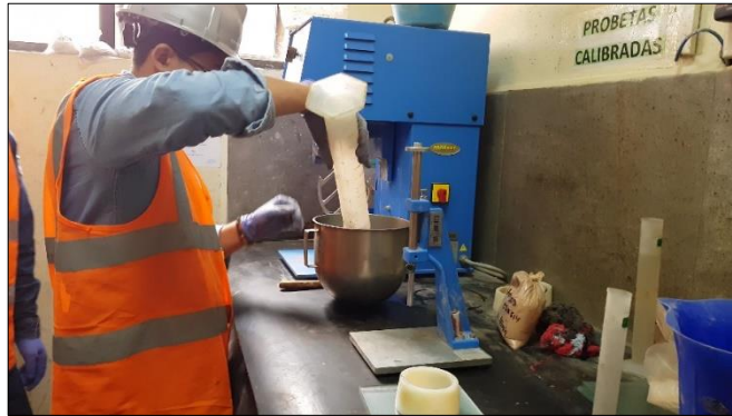
Figura 12 Colocación del agua a la mezcla. Fuente: Félix Castillo Jumbo – Ronny Reyes Villamar.
