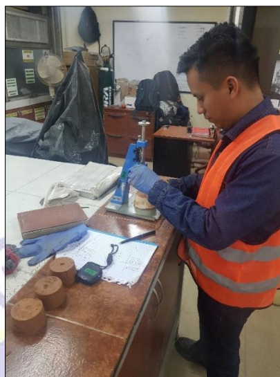
Figura 20 Lectura de la penetración de la aguja de Vicat. Fuente: Félix Castillo Jumbo – Ronny Reyes Villamar.
