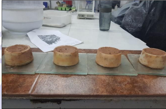
Figura 21 Determinación de tiempo fraguado final. Fuente: Félix Castillo Jumbo – Ronny Reyes Villamar.
