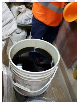
Figura 3 Intensificador de molienda MTDA 290 Fuente: Félix Castillo Jumbo – Ronny Reyes Villamar.
