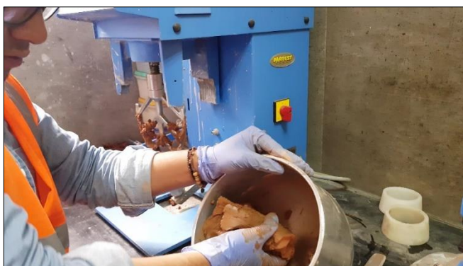
Figura 10 Amasado de la muestra. Fuente: Félix Castillo Jumbo – Ronny Reyes Villamar.
