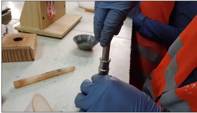
Figura 7 Pisón para colocar el papel filtro y compactar ligeramente la muestra. Fuente: Félix Castillo Jumbo – Ronny Reyes Villamar.
