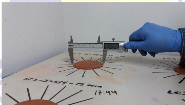
Figura 16 Medición de diámetros de las muestras con el calibrador de Vernier. Fuente: Félix Castillo Jumbo – Ronny Reyes Villamar.
