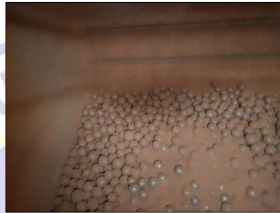
Figura 4 Material LC2 una vez realizada la molienda Fuente: Félix Castillo Jumbo – Ronny Reyes Villamar.
