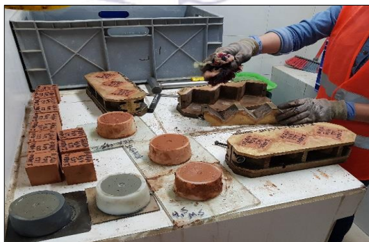
Figura 17 Cubos de 50 x 50 mm para Ensayo de resistencia a la compresión. Fuente: Félix Castillo Jumbo – Ronny Reyes Villamar.
