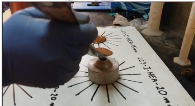
Figura 14 Colocación de la muestra mezclada en el molde. Fuente: Félix Castillo Jumbo – Ronny Reyes Villamar.
