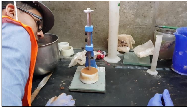
Figura 11 Prueba inicial para comprobar la penetración. Fuente: Félix Castillo Jumbo – Ronny Reyes Villamar.
