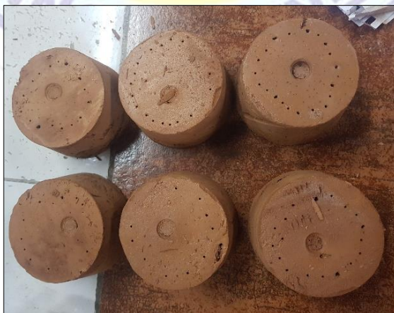
Figura 22 Muestras ensayadas para tiempo de fraguado. Fuente: Félix Castillo Jumbo – Ronny Reyes Villamar.
