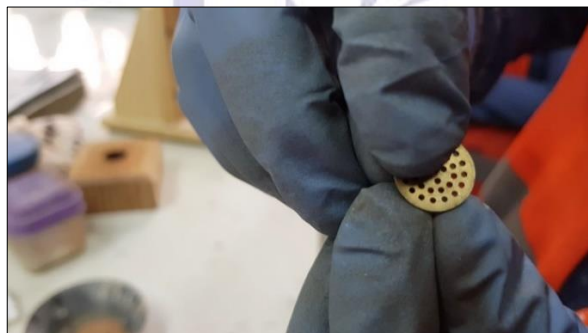
Figura 6 Filtro metálico para Ensayo de Blaine. Fuente: Félix Castillo Jumbo – Ronny Reyes Villamar.
