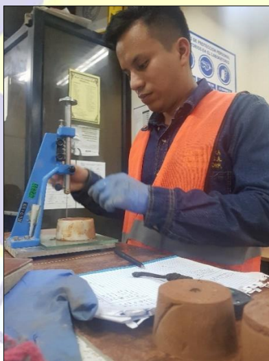
Figura 19 Penetración de la aguja de Vicat. Fuente: Félix Castillo Jumbo – Ronny Reyes Villamar.
