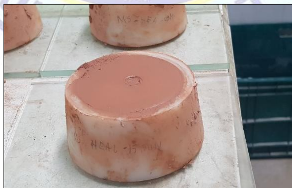
Figura 18 Moldes con muestras para el Ensayo de tiempo de fraguado. Fuente: Félix Castillo Jumbo – Ronny Reyes Villamar.
