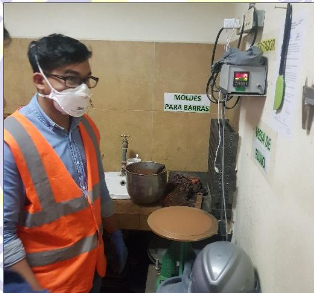
Figura 13 Ensayo de la mezcla en la mesa de flujo. Fuente: Félix Castillo Jumbo – Ronny Reyes Villamar.
