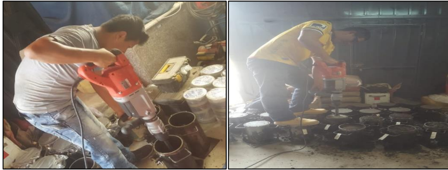
Figura 10. Martillo Vibrador Para Probetas Suelo Cemento. Fuente: Enrique Carvajal De La Rosa – Darwin Pozo Tomalá.
