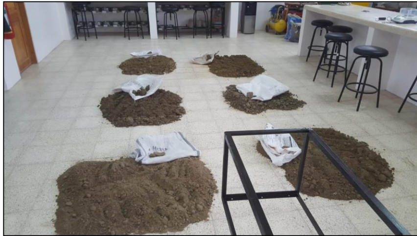
Figura 9. Proceso de cuarteo de muestras.
