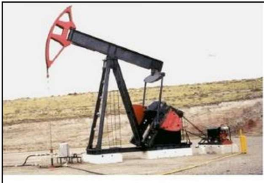
Figura 2-17 Unidad convencional de bombeo mecánico. Fuente: Manual de optimización de bombeo mecánico
