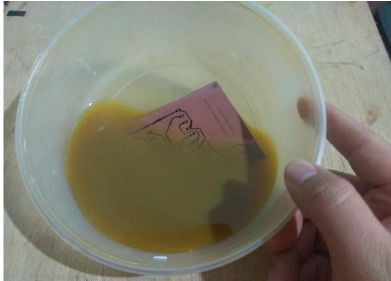
Figura 28. Baquelita en ácido férrico para quitar el cobre. Elaborado por el autor
