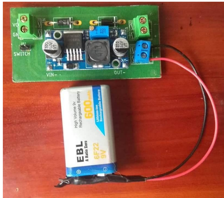
Figura 31. Sistema de alimentación del panel domótico ensamblado. Elaborado por el autor.
