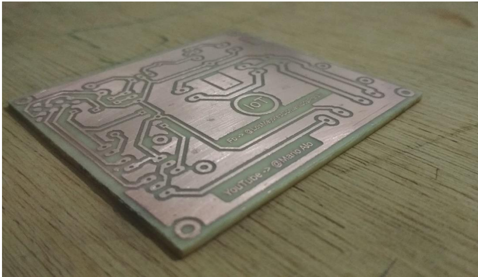
Figura 40. Placa PCB del interruptor inalámbrico listo para realizar los agujeros. Elaborado por el autor.
