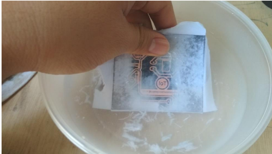
Figura 38. Método termotransferible aplicado en el circuito impreso del interruptor inalámbrico. Elaborado por el autor.
