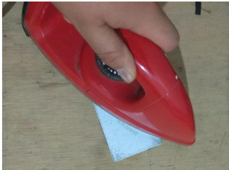
Figura 25. Planchado del circuito. Elaborado por el autor.
