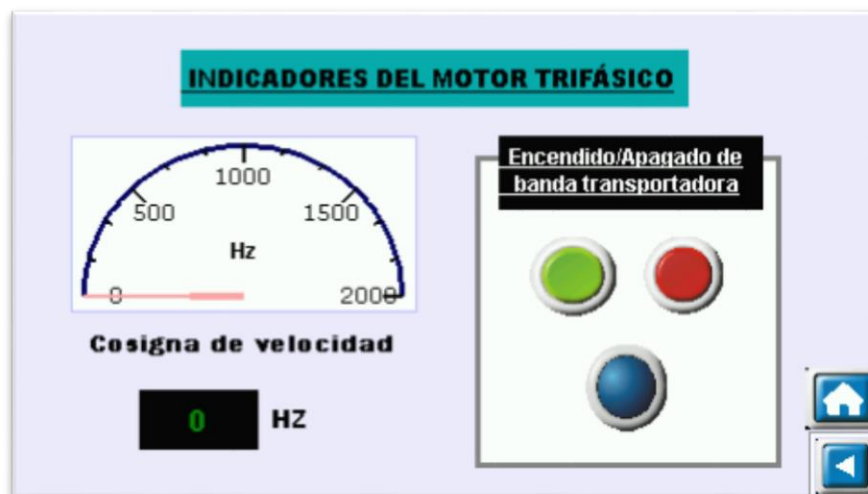
Figura 39: Pantalla de parámetros del variador VFD-EL
