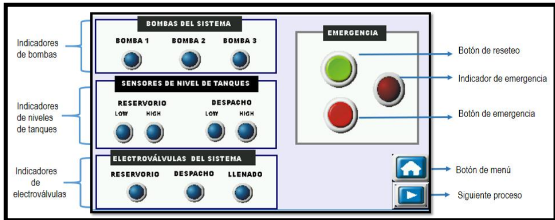
Figura 38: Pantalla de indicadores de tanques del HMI
