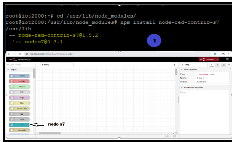
Figura 61: Instalación del node s7
