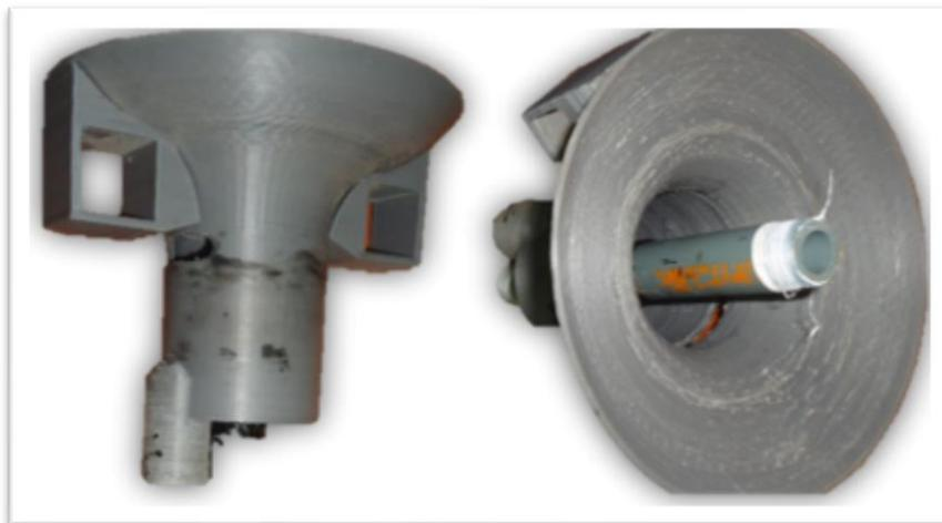
*Figura 26 Soporte para el lavado de botellones impreso en 3D*
