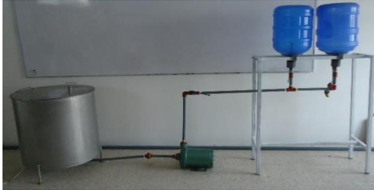
Figura 4 estructura del proceso de lavado para botellones de agua
