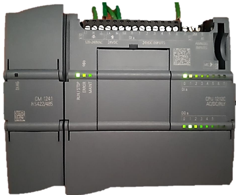
Figura 8. Controlador Lógico Programable SIMATIC S7-1200 CPU 1212.
