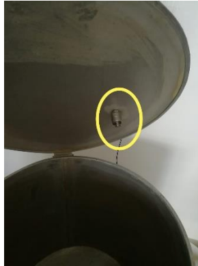
Figura 26: Ubicación del sensor flotador de 7 cm.
