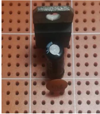
Figura 24: Regulador de voltaje para el sensor infrarrojo
