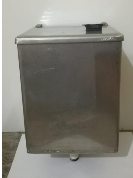
Figura 11: Tanque de depósito de solución del dióxido de cloro
