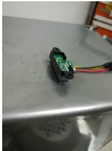
Figura 23: Ubicación del sensor infrarrojo
