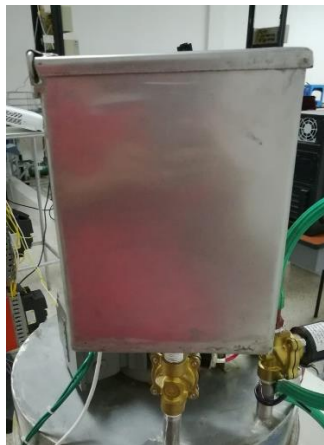
Figura 19: Tanque de dosificación
