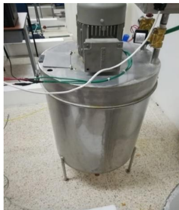
Figura 17: Tanque de mezcla
