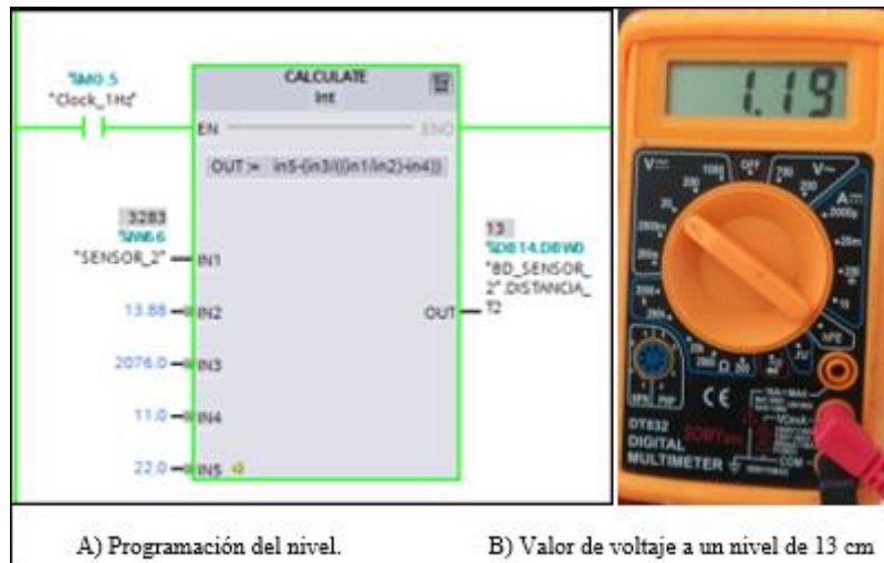
Figura 73: Valores obtenidos de la calibración del sensor infrarrojo.
