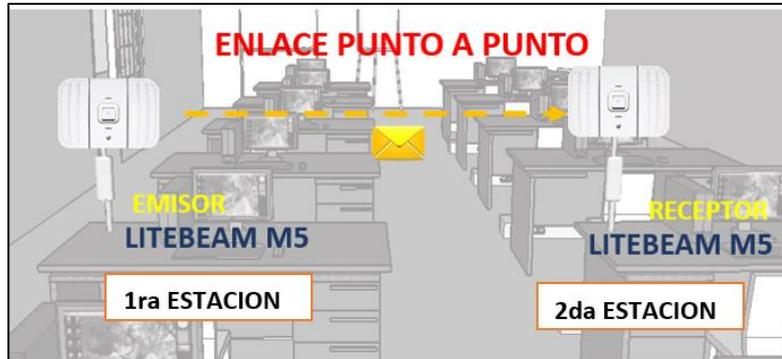
Figura 46: Ubicación de equipos (enlace PtP) - Lab. de Telecomunicaciones.
