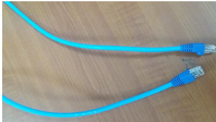
Figura 61: Cable UTP categoría 6 ponchado al rj-45
