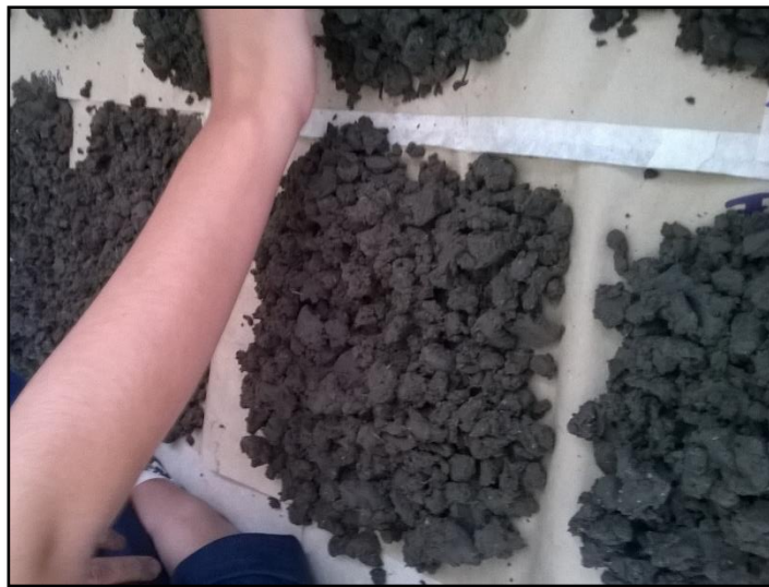
Figura A 4. Secado de muestras de suelo
