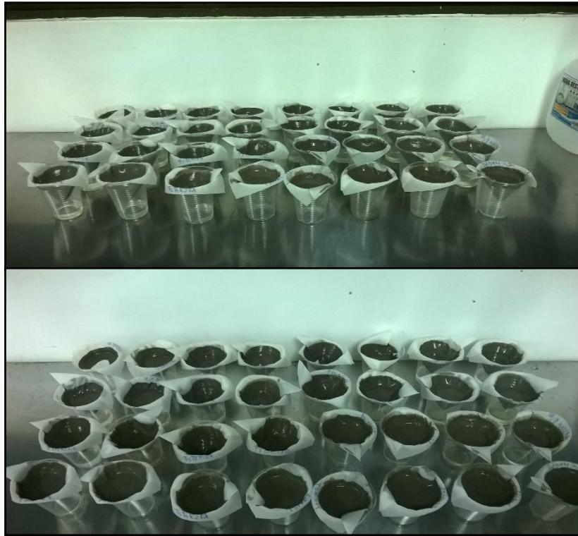
Figura A 5. Proceso de laboratorio para la obtención del pH y Ce (S/m)
