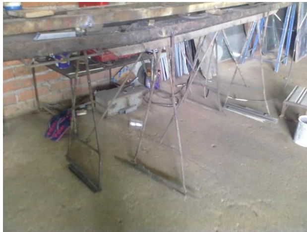
Imagen 11: Mesa de soldar inestable
