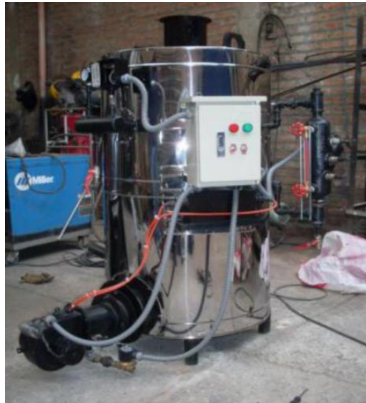
Imagen 6: Caldera de 5 hp.
