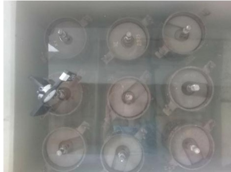
Figura 34: Especímenes de CBR en piscina de inmersión
