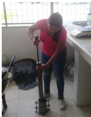
Figura 32: Ensayo de proctor modificado
