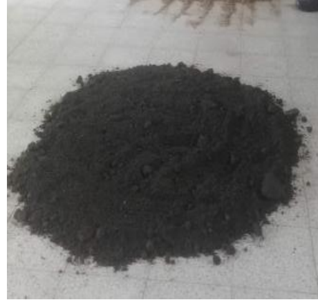
Secado de Arenas asfálticas
