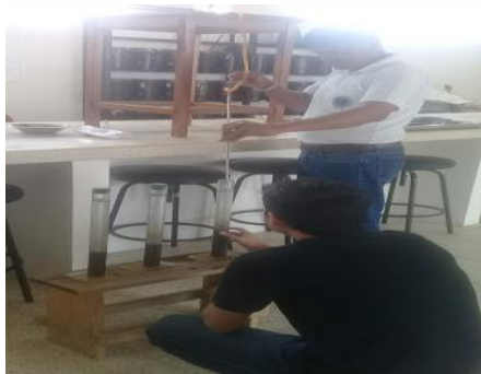
Figura 40: Adición de la solución mediante el sifón
