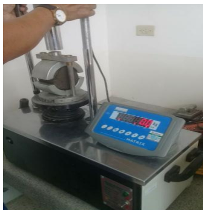
Figura 39: Aplicación de la carga a la probeta Marshall
