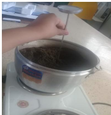
Figura 38: Preparación de muestra para estabilidad Marshall
