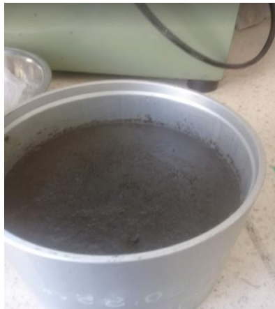
Mezclado de Arenas Asfálticas y agua
