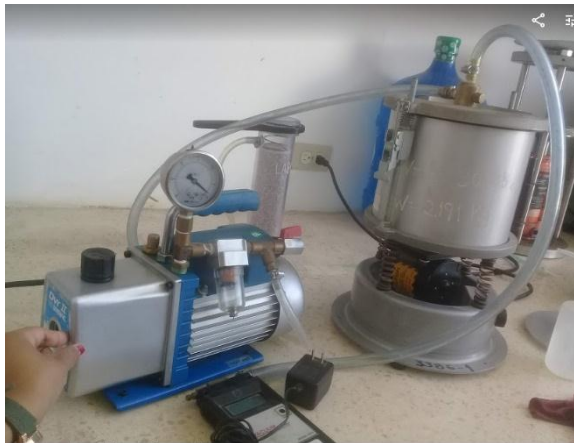
Figura 36: Densidad teórica máxima-RICE
