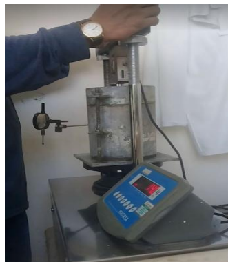
Aplicación de carga de penetración
