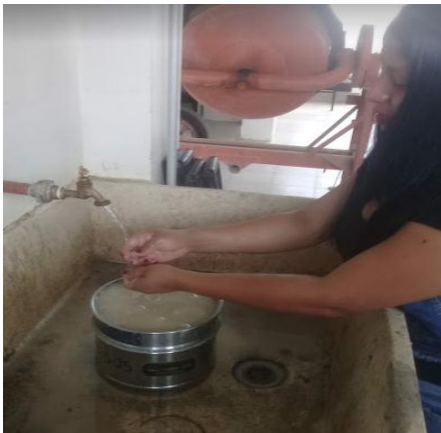
Lavado de finos de suelo de subrasante
