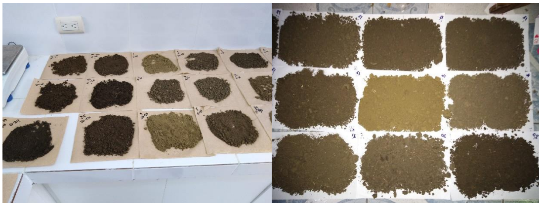
Figura 4A. Secado al ambiente de las muestras, previo al análisis de laboratorio.
