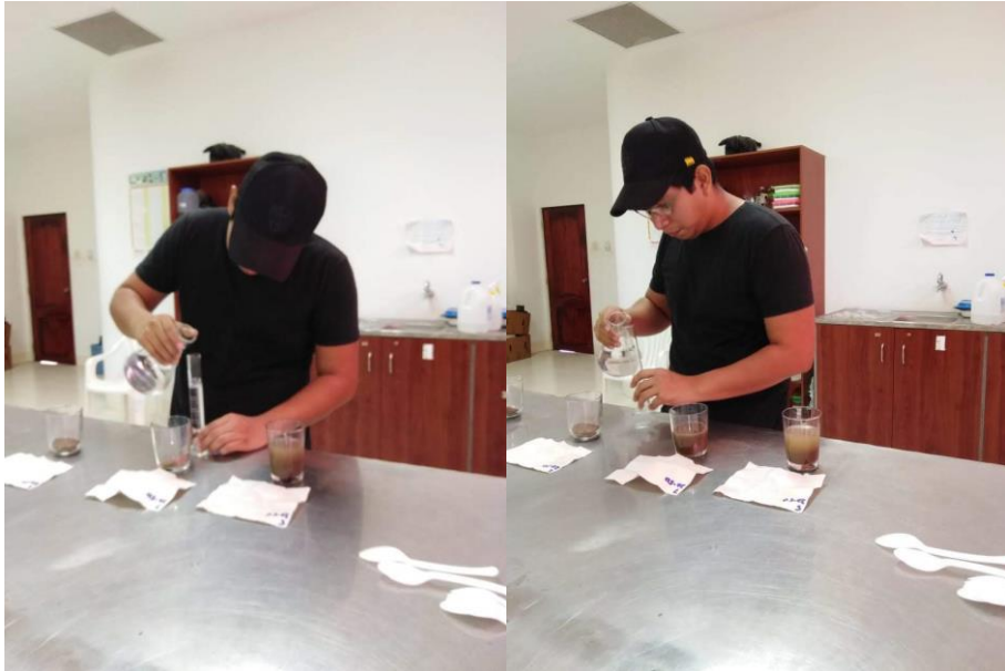
Figura 7A. Preparación de la solución 1:5 (una parte de suelo y 5 de agua)
