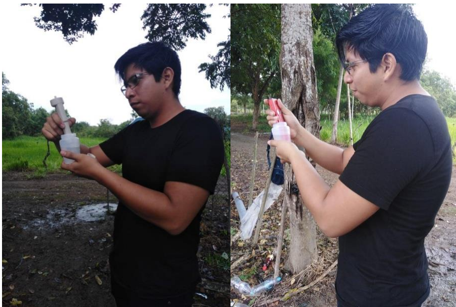
Figura 12A. Medición de CE y pH de las aguas del Centro de Apoyo Manglaralto UPSE
