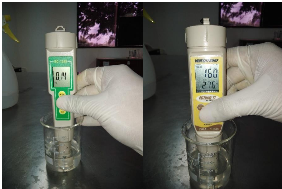
Figura 9A. Medición de CE en solución de 1:5
