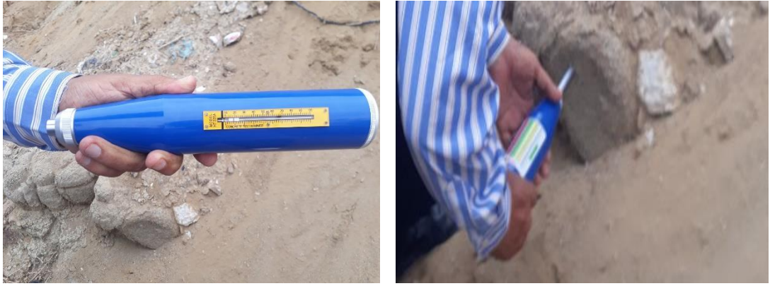
Foto 15. Medición de la resistencia de la roca con el esclerómetro.
