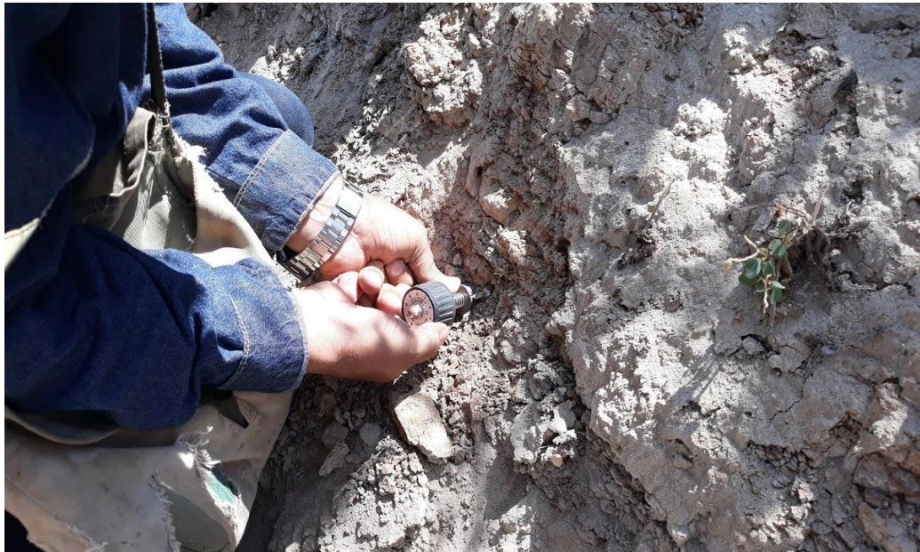
Foto 13. Medición de la resistencia de la roca con el equipo de la veleta – no funciona el ensayo.
