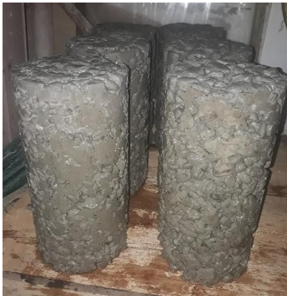
Figura 4. Probetas de hormigón con diferentes mezclas a ensayar Fuente: C Merchán; E. Alejandro
