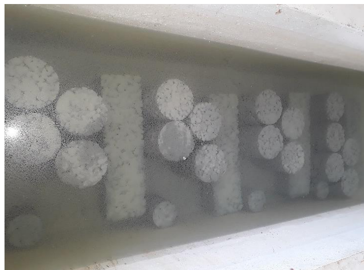
Figura 6. Curado de probetas de hormigón permeable Fuente: C Merchán; E. Alejandro
