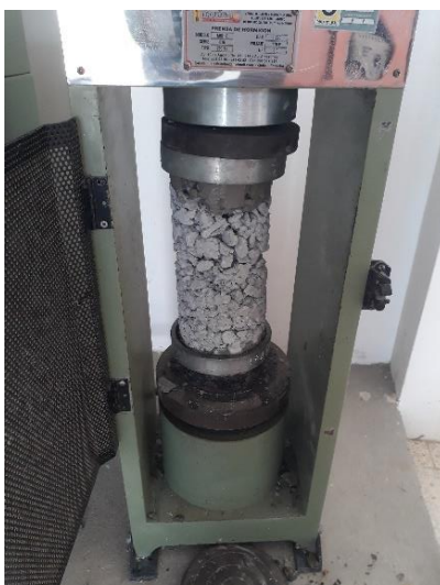
Figura 7. Rotura de cilindros mediante el uso de la prensa hidráulica Fuente: C Merchán; E. Alejandro
