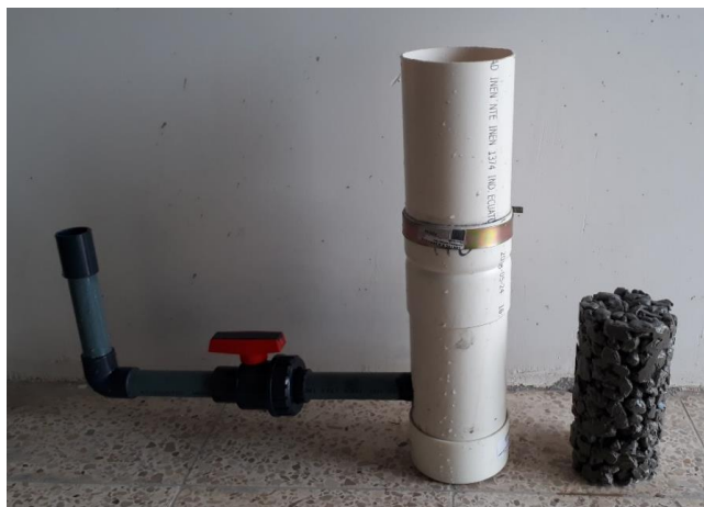
Figura 9. Permeámetro para especímenes de hormigón permeable. Fuente: C Merchán; E. Alejandro
