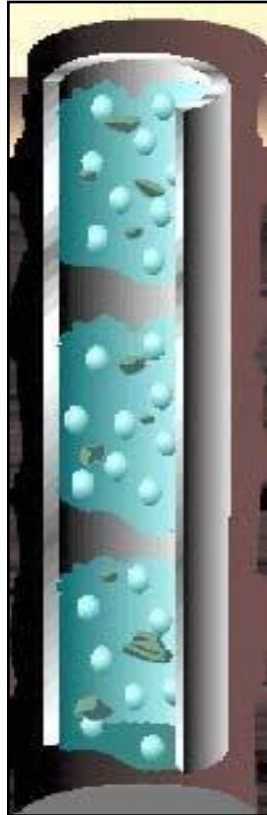
Figura 2:8 TRANSPORTE DE CORTES CON FLUIDOS GASIFICADOS
