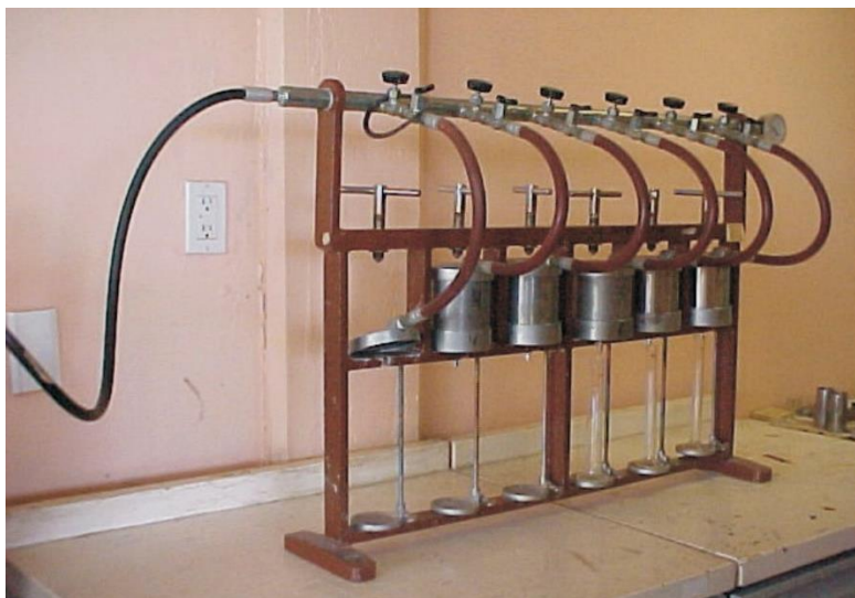
Figura 2:25 CÁMARAS DE FILTRACIÓN DE BAJA PRESIÓN
