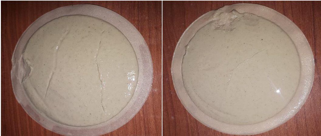
Figura 6:10 COSTRA FORMADA POR EL FILTRADO Elaborado por Elvis Enrique Merchán Chancay
