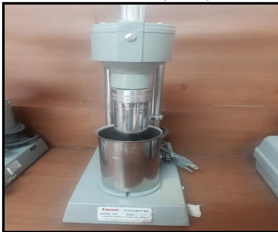
Figura 6:6:4 Viscosímetro Fann 6 velocidades
