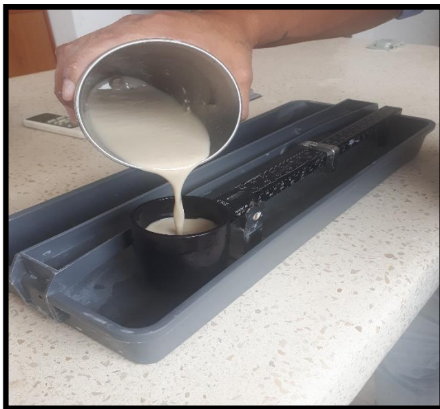
Figura 6:7 MEDICIÓN DE LA DENSIDAD DEL LODO
