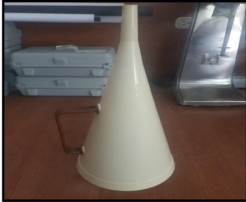
Figura 6:6:3 Embudo de Viscosidad
