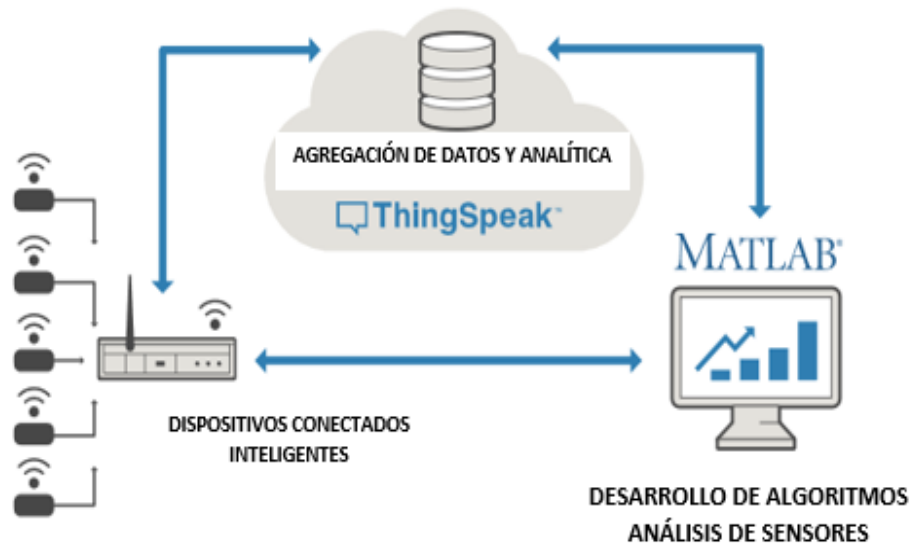
Figura 28: Ejemplo de envío de datos a la Plataforma ThingSpeak [37].
