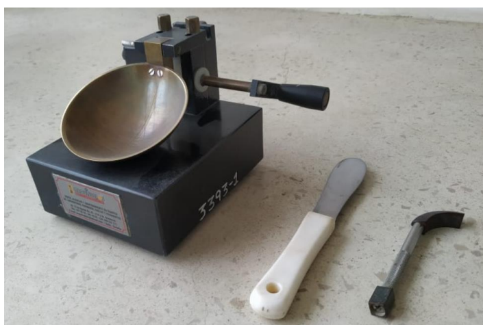
Figura 25 Dispositivo mecánico para límite líquido Fuente: Carlos Soria – Lizbeth Vera
