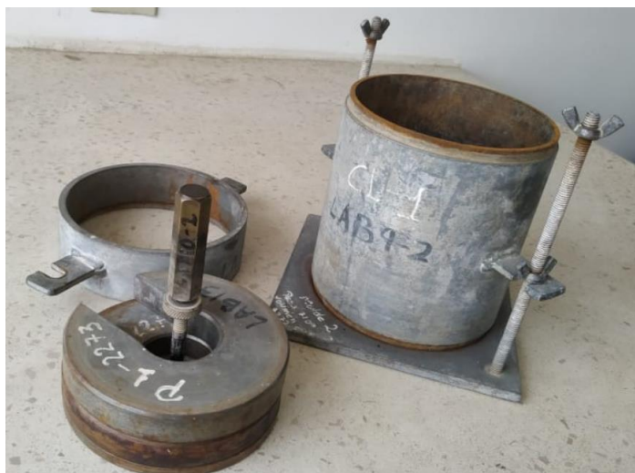
Figura 26 Molde para realizar el ensayo de proctor modificado Fuente: Carlos Soria – Lizbeth Vera
