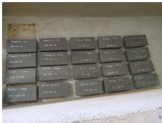
Figura 35 Curado del adoquín Fuente: Autores C. Soria – L. Vera
