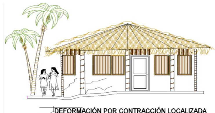
Fotografía 5 Deformación por contracción localizada.
