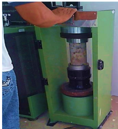
Figura 5. Ruptura de cilindros mediante el uso de la prensa Hidráulica Fuente: W. Moreira; C. Manzaba
