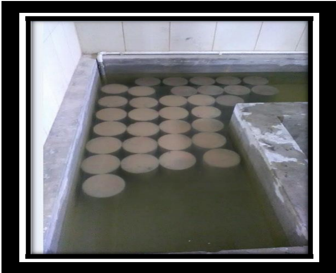
Curado del hormigón
