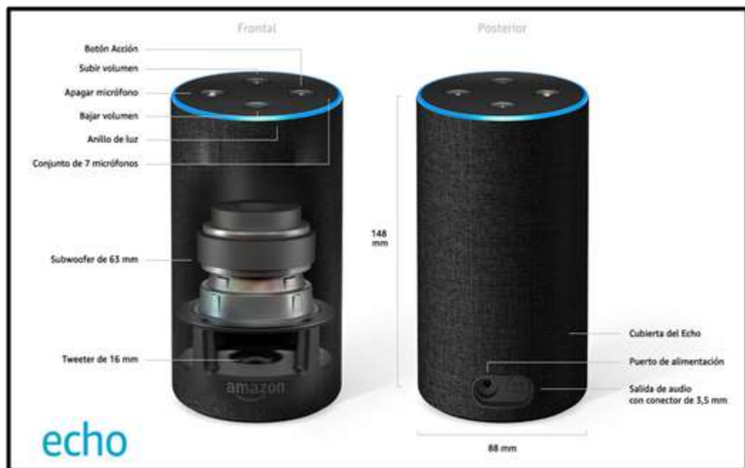
Figura 3. Partes específicas de un dispositivo Echo Plus que trabaja con Alexa [22].
