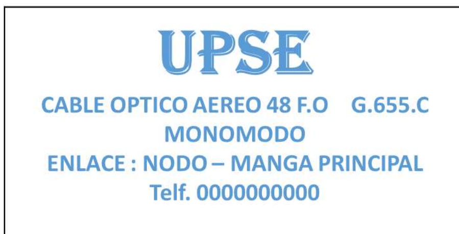
Figura 47. Etiqueta de identificación aérea 12 x 6 cm. Diseño de etiqueta elaborada por el autor.
