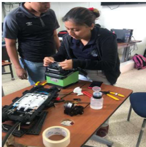
Anexo 6. Fusión por divisiones ópticas en la red GPON.
