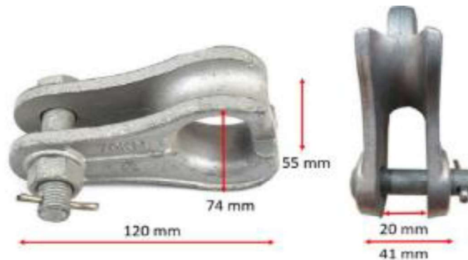
Figura 37. Especificación técnica del herraje Thimble Cleavies. Imagen tomada de los equipos a utilizarse.
