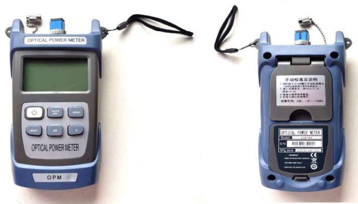
Figura 43. Power Meter. Imagen tomada de los equipos a utilizarse.
