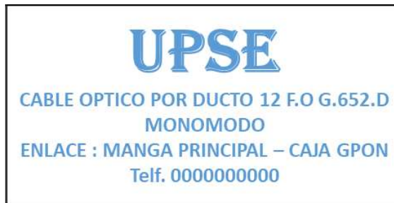
Figura 48. Etiqueta de identificación aérea 8 x 4 cm Diseño de etiqueta elaborada por el autor.
