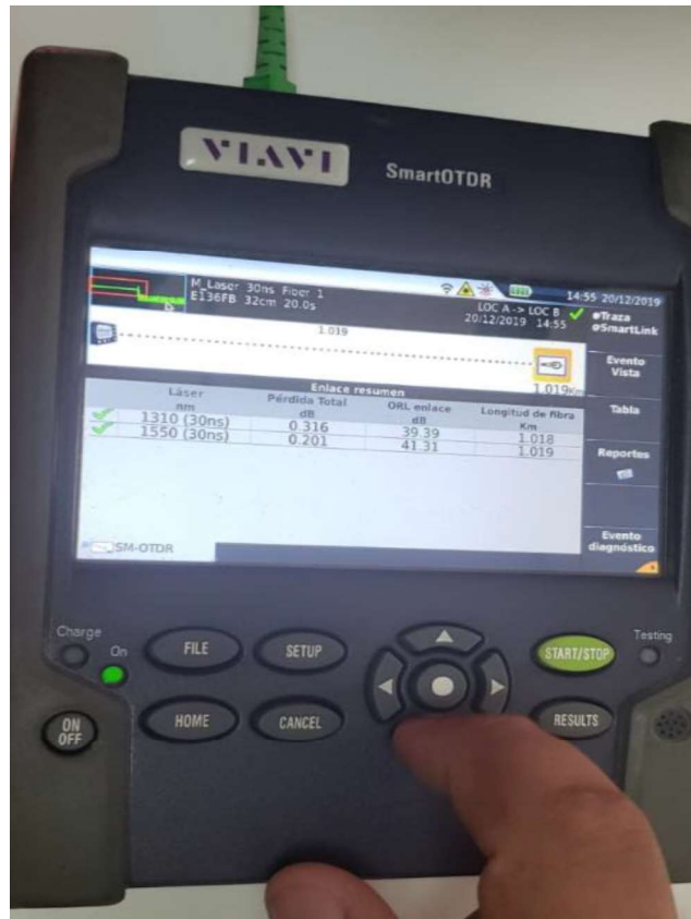
Figura 57. Resultado de pérdidas con el OTDR. Imagen tomada de los cálculos realizados.
