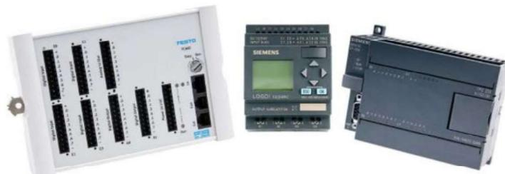
*Figura 6 Ejemplos de PLC compactos distintos fabricantes tomado de artículo "ingeniería de sistemas industriales "*
