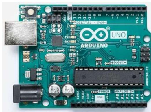
*Figura 34 Placa arduino UNO. tomado de tienda oficial de arduino*
