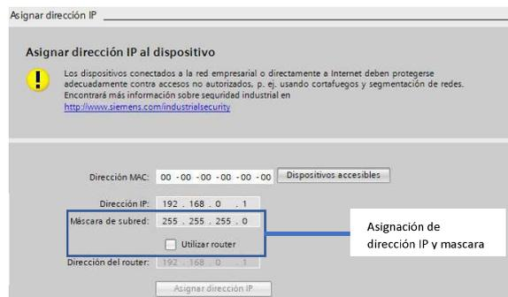
Figura 50 Asignación de dirección ip y mascara para configurar el plc. elaborado por autor
