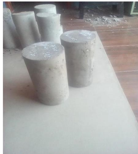
**Figura 34:** Cilindros de hormigón.
