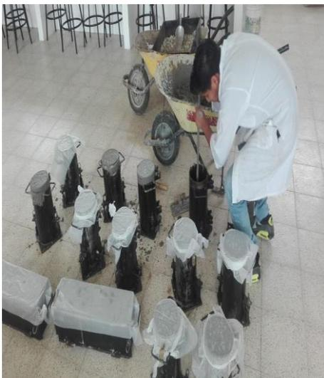
**Figura 30:** *Vaciado y fundición de las probetas de hormigón.*
