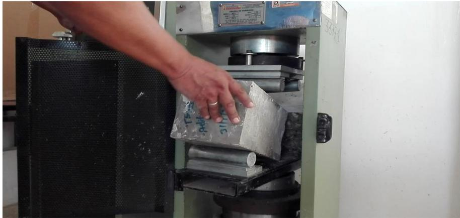
**Figura 37:** Ensayo de flexión de las vigas de hormigón.
