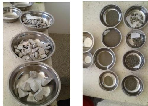
**Figura 23:** Tamizado de agregado grueso.
