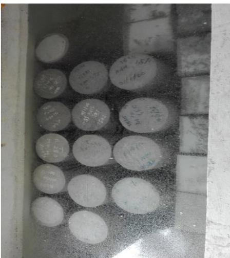
**Figura 33:** Curado de especímenes de hormigón.
