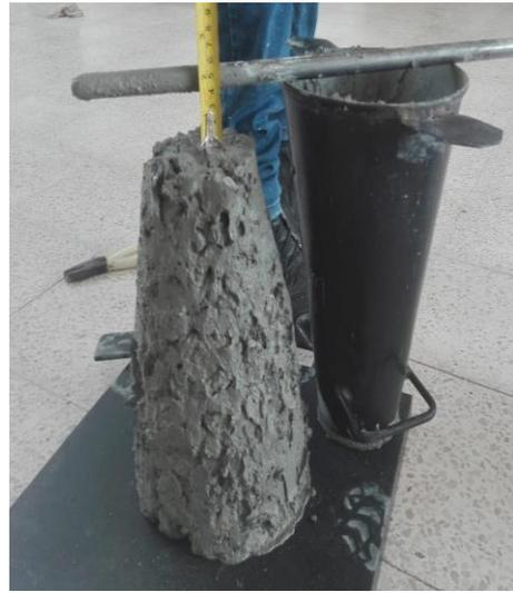
**Figura 27:** *Ensayo de Asentamiento del hormigón (Cono de Abraham).*
