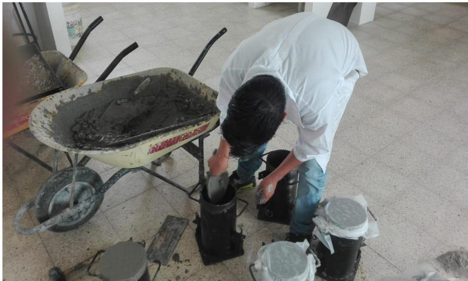
**Figura 28:** *Elaboración de las probetas de hormigón.*
