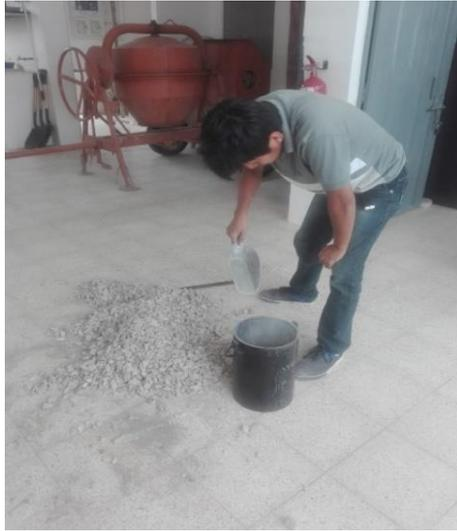
**Figura 24:** Ensayo del peso volumétrico varillado del agregado grueso.
