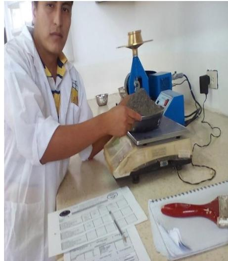
**Figura 21:** Ensayo de determinación de material más fino.
