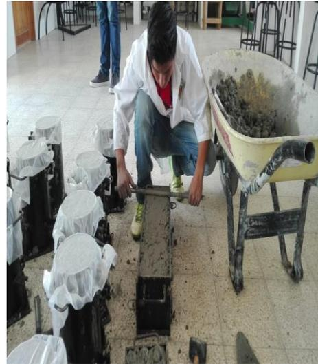
**Figura 29:** *Elaboración de las vigas de hormigón.*
