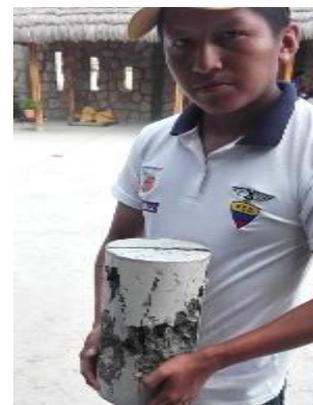
Figura 36: Ensayo de compresión de las probetas de hormigón.
