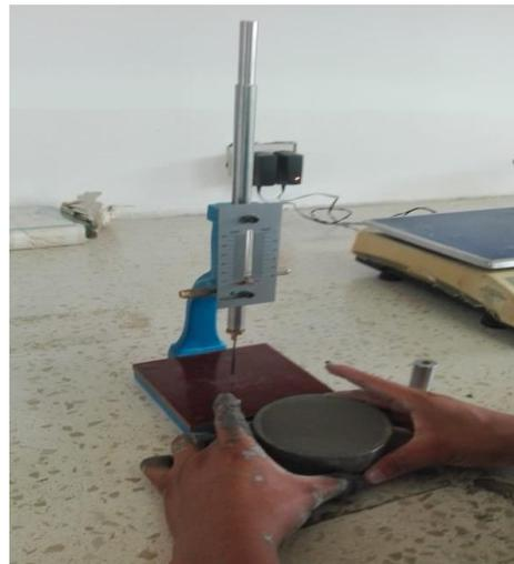
**Figura 32:** Ensayo de tiempo de fraguado del hormigón.
