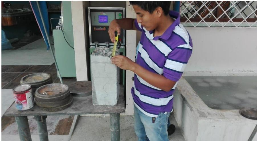
**Figura 38:** Mediciones de las fisuras de las vigas de hormigón para el cálculo del módulo de rotura.
