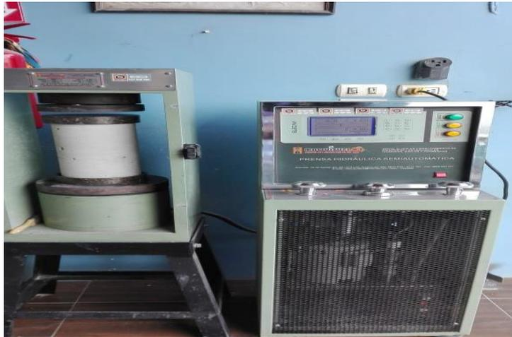
Figura 35: Prensa hidráulica para ensayo de compresión y flexión.
