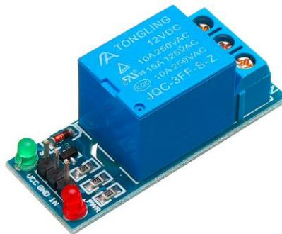
Figura 19: Modulo rele 12v.
