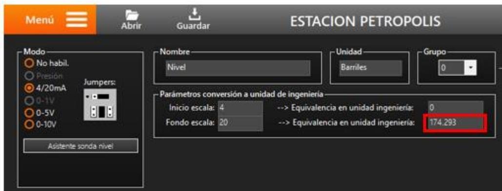
Figura 34: Configuración de entradas analógicas. Autor: Orly Medina.
