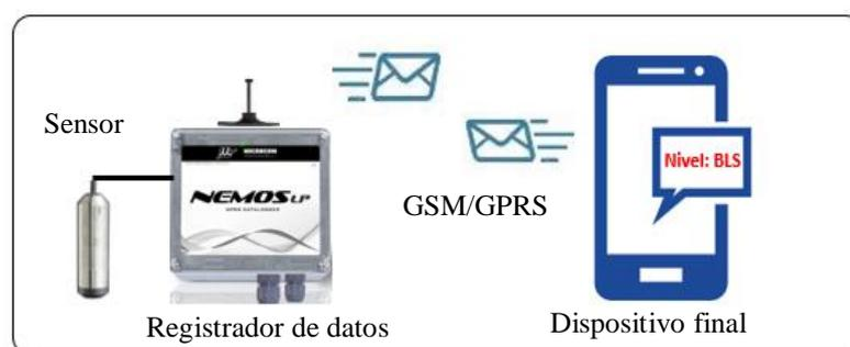
Figura 8: Sistema de telemetría por medio de la red celular. Autor: Orly Medina.
