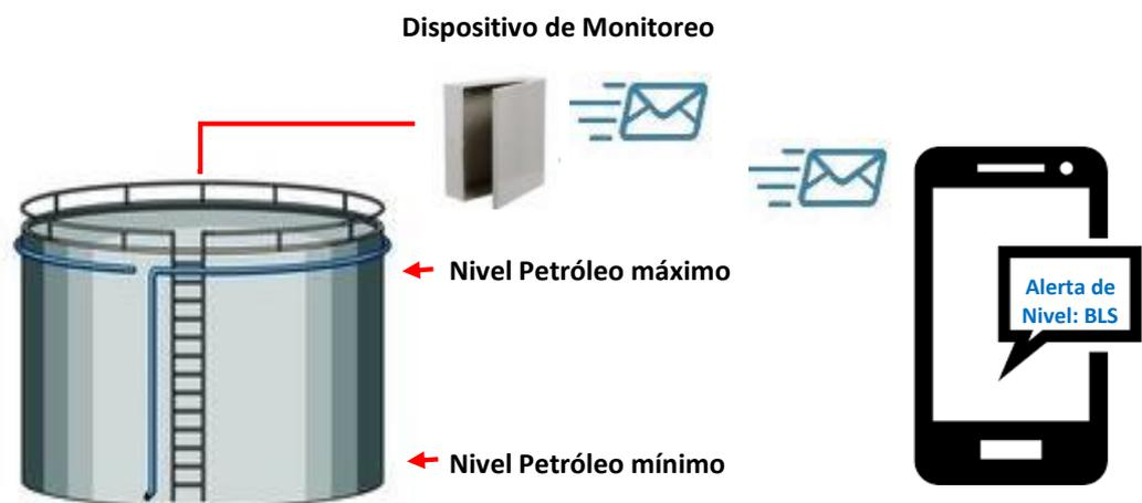
Figura 4: Esquema de sistema de notificaciones. Autor: Orly Medina.
