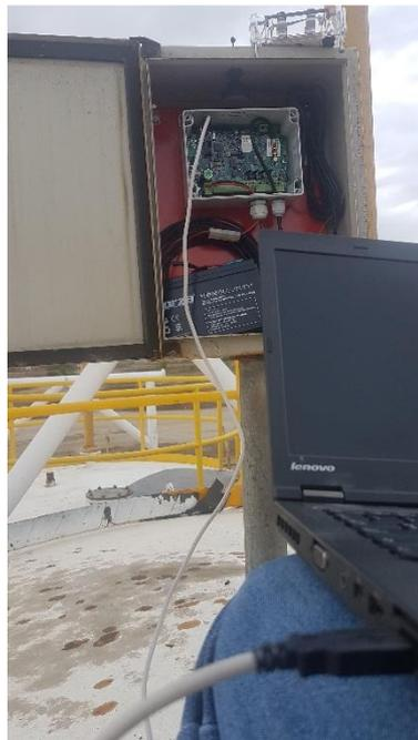
Figura 41: Calibración del nivel de petróleo. Autor: Orly Medina.
