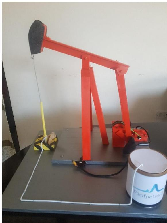
Figura 40: Prototipo del balancín. Autor: Orly Medina.
