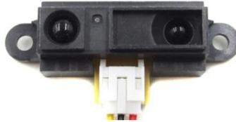
Figura 16: sensor de distancia para prototipo de control del balancín.
