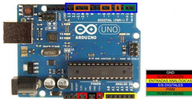
Figura 28: esquema de pines en Arduino Uno [35].
