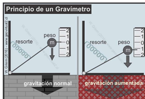
Figura 11. Principio Físico del Gravímetro. Fuente: (Griem, 2020).
