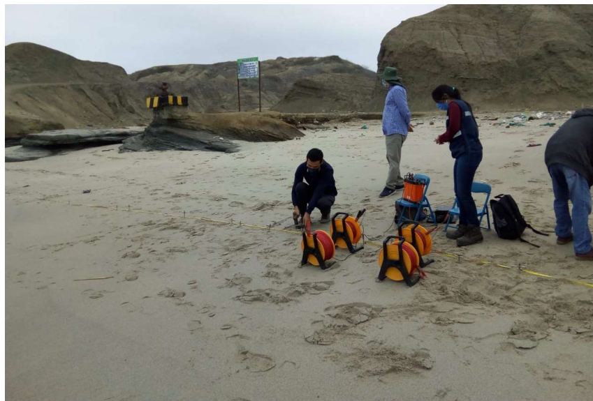
Figura 23. Arreglo de Electrodos AB/2 y MN/2 en el Pozo ANC0001. Fuente: Mora C., 2020.
