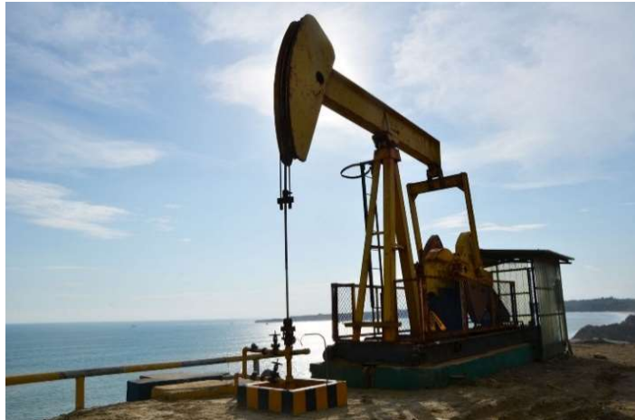
Figura 6. Levantamiento Artificial por Bombeo Mecánico. Fuente: Pacifpetrol
