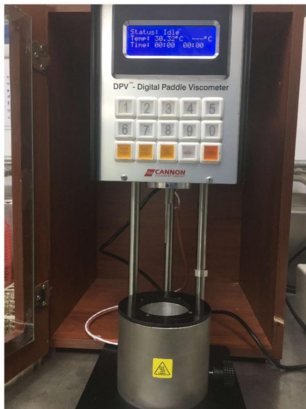
Figura 5.2.1 Viscosímetro digital de paletas (DPV) Cannon
