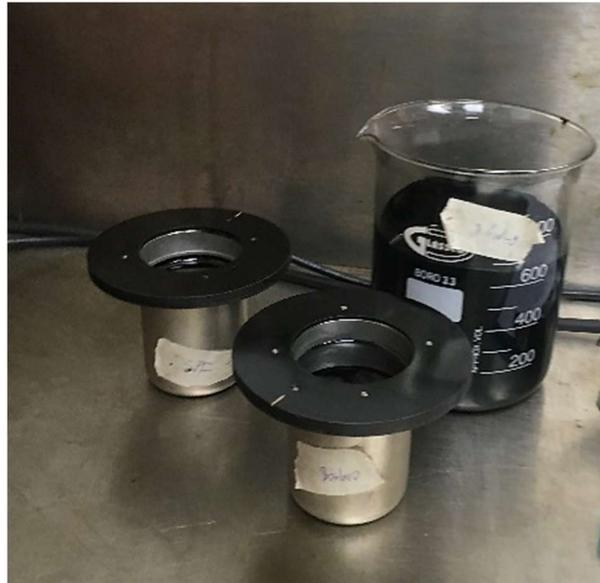
*Figura 5.3.1 Mezcla Crudo SPF y Residuo Topping para obtener el crudo Blending.
