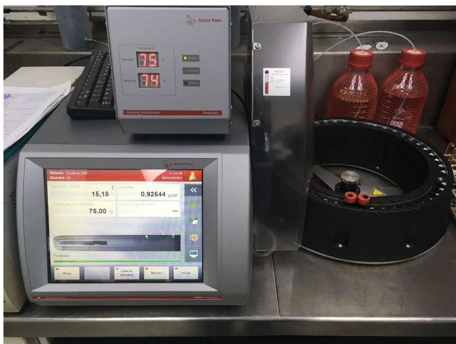
Figura 5.2.2 Densímetro Anton Paar DMA 4500 M.
