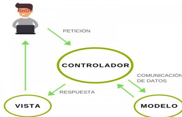
*Ilustración 6 Arquitectura 2- Modelo Vista Controlador*
