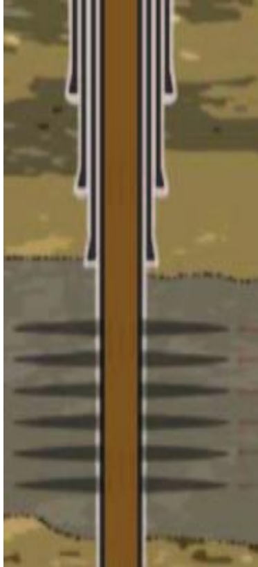
Figura 28: A) ANTES DEL DISEÑO B) POZO TAPONADO Fuente: (JET 14 - Introducción a la cementación, 2014)
