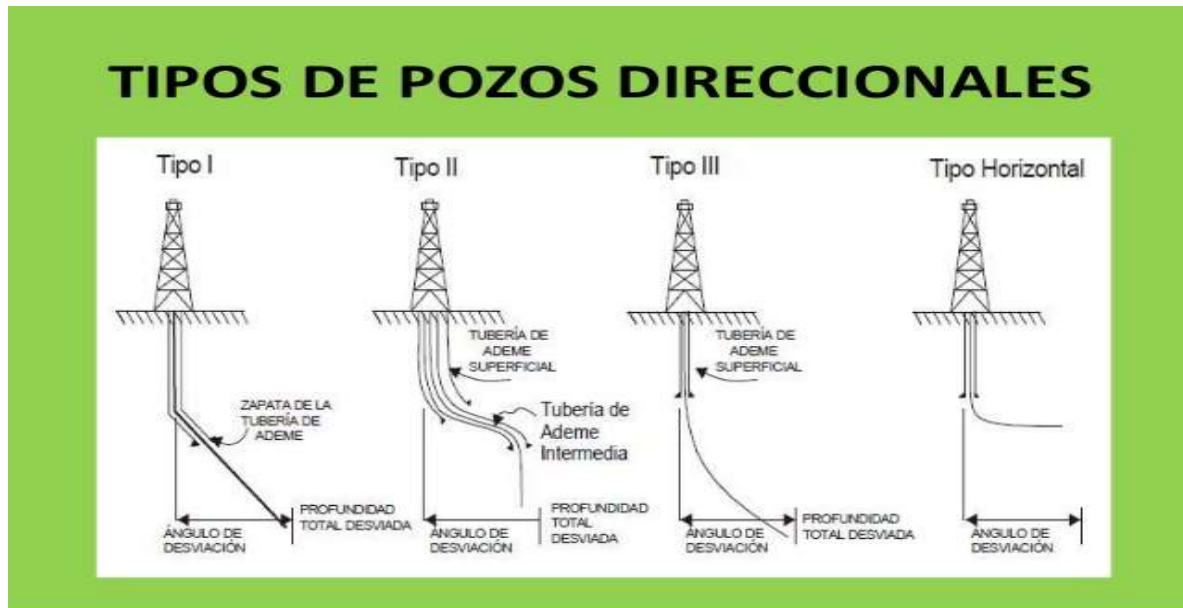
Gráfica. 7 Tipos de Pozos Direccionales
