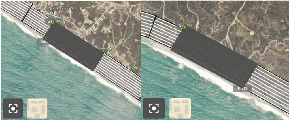
*Nota.* Aplicación móvil Pix4Dcapture para levantamiento fotogramétrico.
