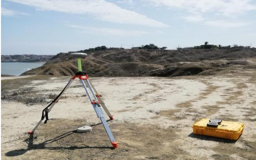
*Nota.* Equipo necesario utilizado con método estático para la toma de coordenadas.
