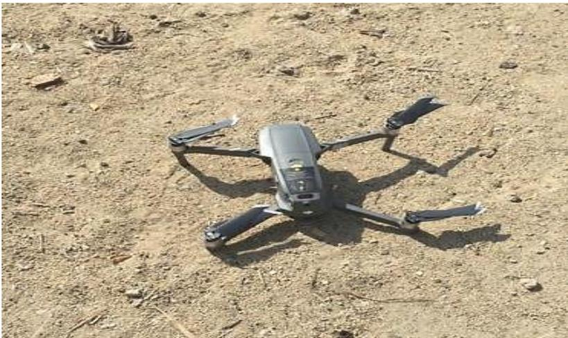
*Nota.* Se observa que el dron está armado y ubicado sobre una superficie plana para un favorable despegue y aterrizaje.
