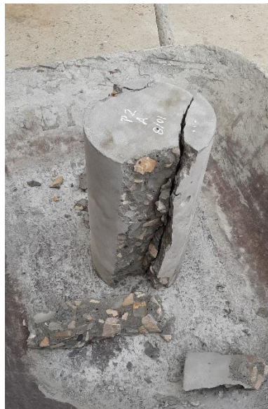
Cilindros después del ensayo a la compresión
