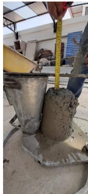
Medición de revenimiento
