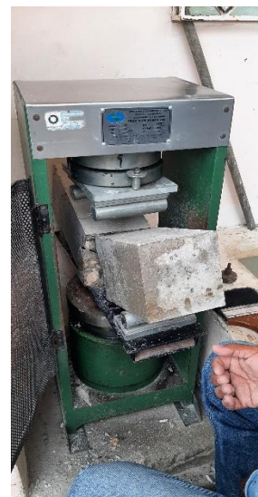
Después del ensayo de flexión
