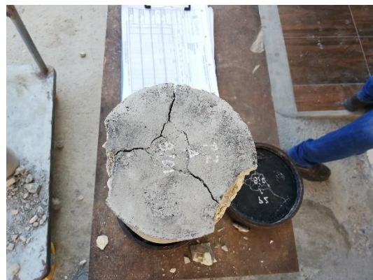
Cilindros después del ensayo a la compresión
