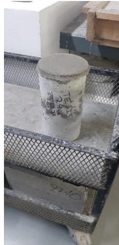
Caqueo del cilindro
