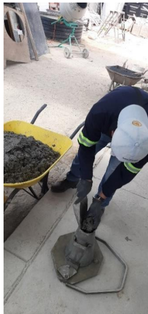
Ensayo de revenimiento
