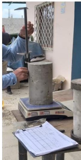
Desencofrado de probetas
