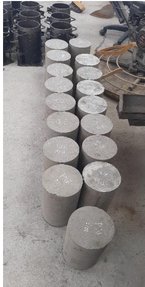
Desencofrado de probetas
